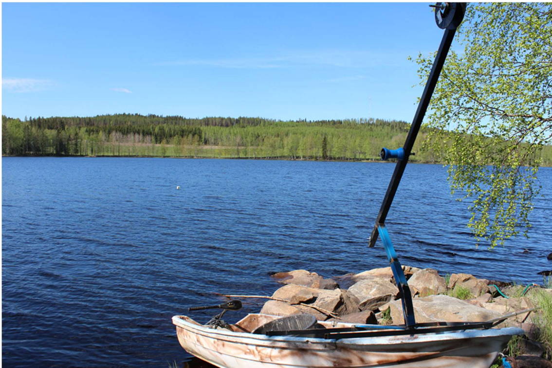
Kuva 1. Nostolaite pultattuna lasikuituveneeseen kokkaan
